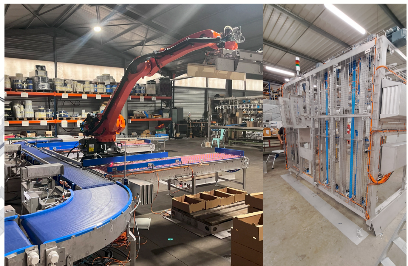
Robot de palettisation bacs et cartons
