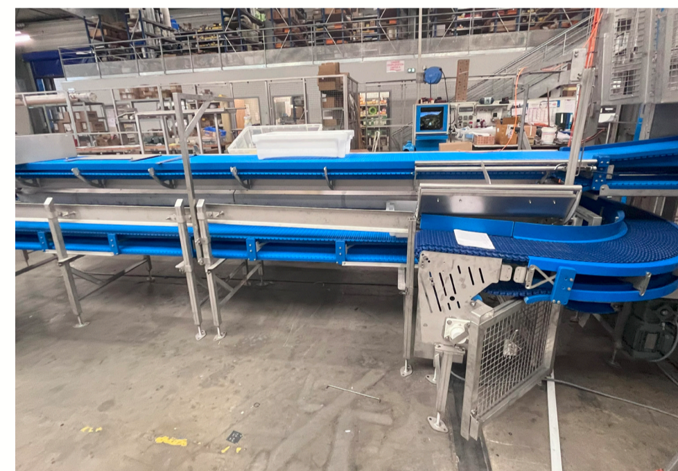
Système de convoyage du dépilateur de bacs
