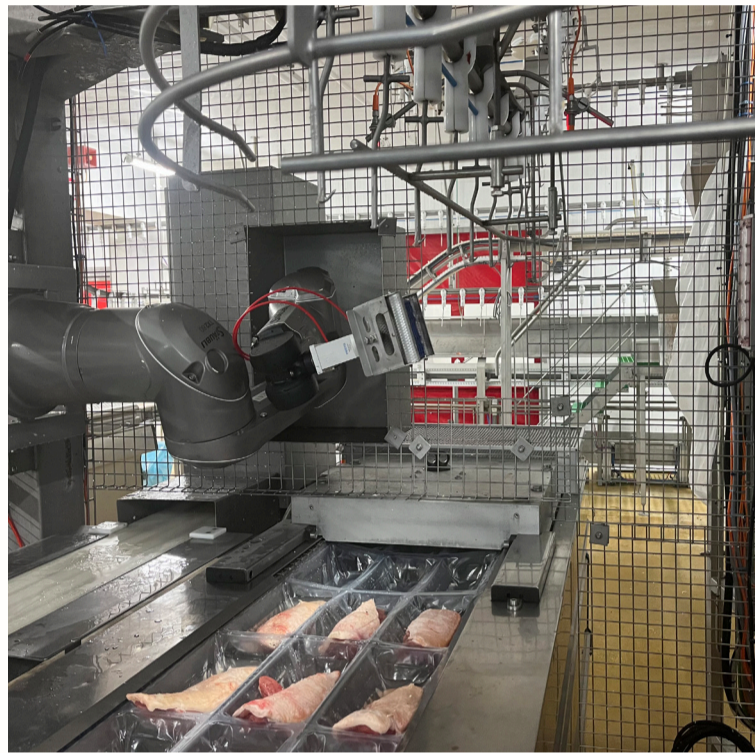
Robot thermoformeuse pour le réaccrochage des filets
