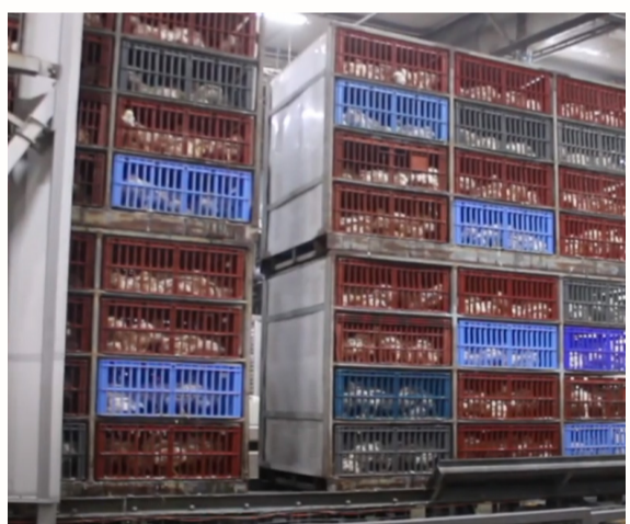
Containers empilés par deux qui seront ensuite dépilés
