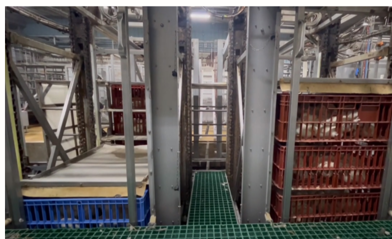
Extraction des caisses du container sur un système double pour un gain de rapidité
