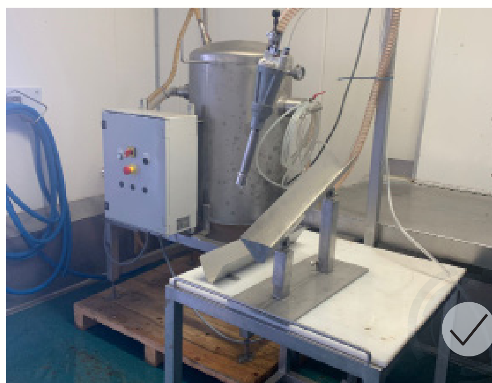
OASPIR-B, la machine d'aspiration par le vide
