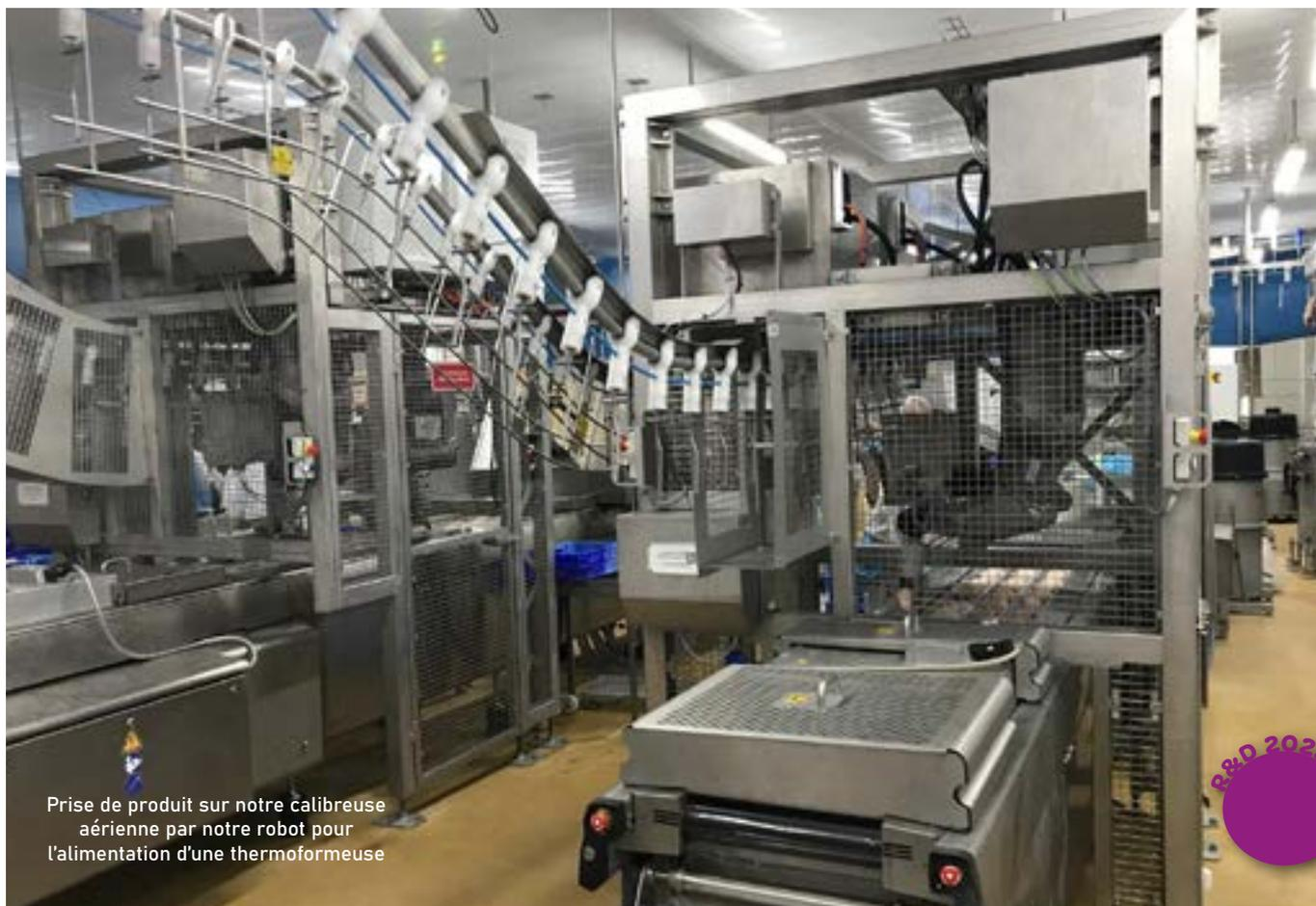
Prise de produit sur notre calibreuse aérienne par notre robot pour l'alimentation d'une thermoformeuse
