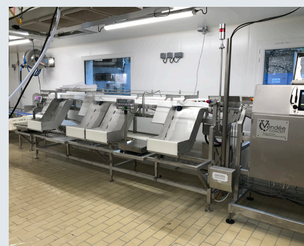
Calibreuse à truites mise en place chez l'un de nos clients
