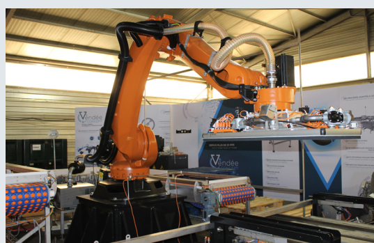
Robot palettiseur-dépalettiseur installé chez un de nos clients dans le secteur de la distillerie
