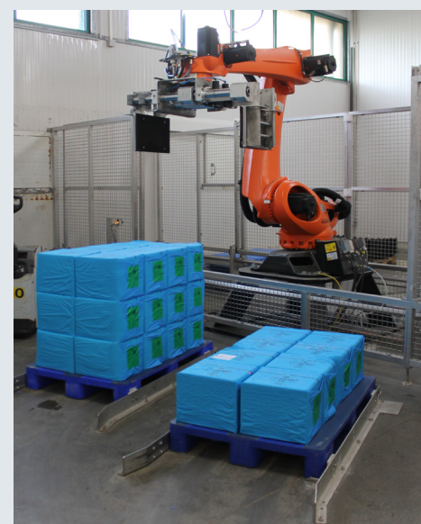
Robot palettiseur-dépalettiseur de cubes de beurre
