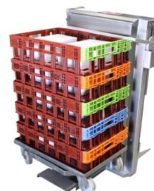
Simple d'utilisation, l'élévateur fonctionne grâce à deux vérins pneumatiques sans tige ; le plateau s'élève automatiquement à l'aide d'une cellule pneumatique. Son châssis composé de roulettes pivotantes permet une mobilité optimale. Afin de faciliter la manutention de bacs, cet élévateur permet de dépiler ou d'empiler une pile de bacs sur rouleur à hauteur d'une zone de travail.
