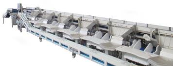
L'équipe de **Vendée concept** est fière de pouvoir vous annoncer sa nouvelle **CALIBRA SL, Station Line**, une solution de découpe individualisée. La **CALIBRA SL** permet de réaliser des opérations de découpe par postes individuels. L'objectif est de **piloter la cadence d'envoi** des produits à chaque poste de désossage, **d'améliorer l'ergonomie des postes de travail** et de **limiter la manutention** liée à la collecte des produits issus de la découpe.
